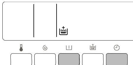
Нажимайте в течение нескольких секунд кнопки “Предварительная стирка” и “Задержка пуска” . Функция окажется включенной постоянно, даже при отключении прибора от электросети.
